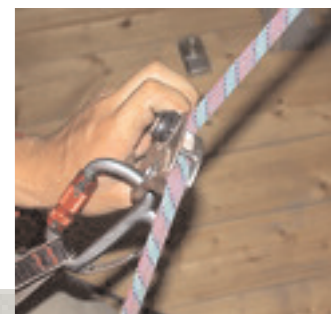
So funktioniert das Ablassen beim »Cinch«
