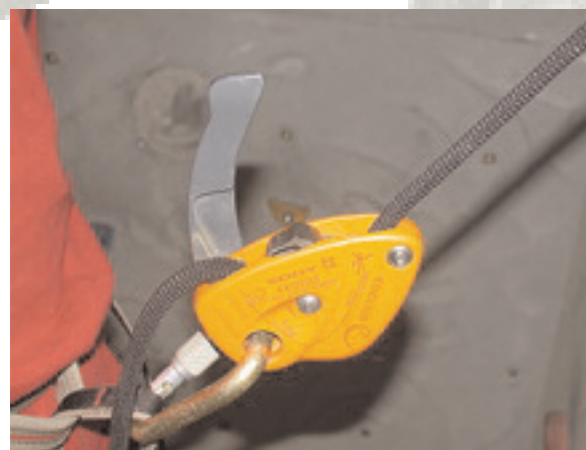
Der Eddy von Edelrid: Kritische Zwischenposition, in der das Gerät nicht blockiert
