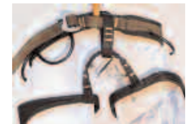
Oben: So haben wir das falsche Einbinden an der Bauchgurtöse simuliert (das Fallgewicht belastete den Karabiner).
