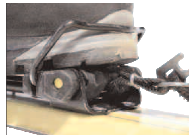
ALLESKÖNNER Vom Skistiefel bis Hochtourenschuh variable Drahtbügel-Vorderbacke mit günstigem Drehpunkt und Fangriemenbefestigung (Alpin-Bindung Silvretta 500)
